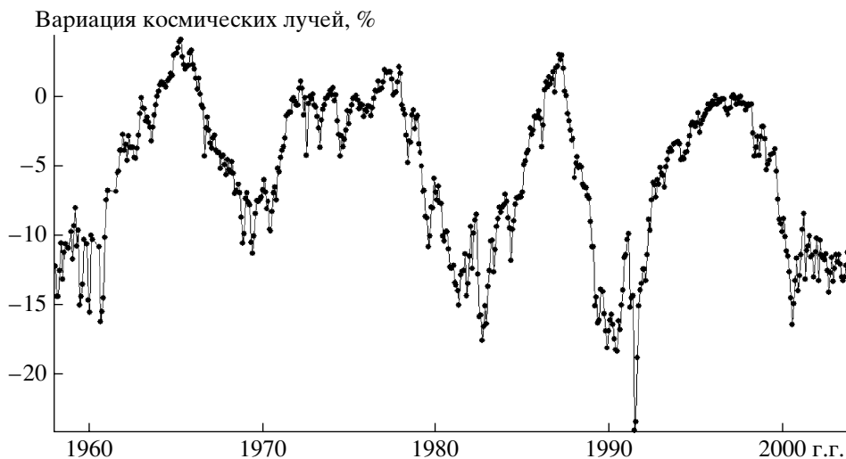
Рис. 34. Долгопериодные вариации КЛ, наблюдавшиеся на нейтронном мониторе ст. Москва.
