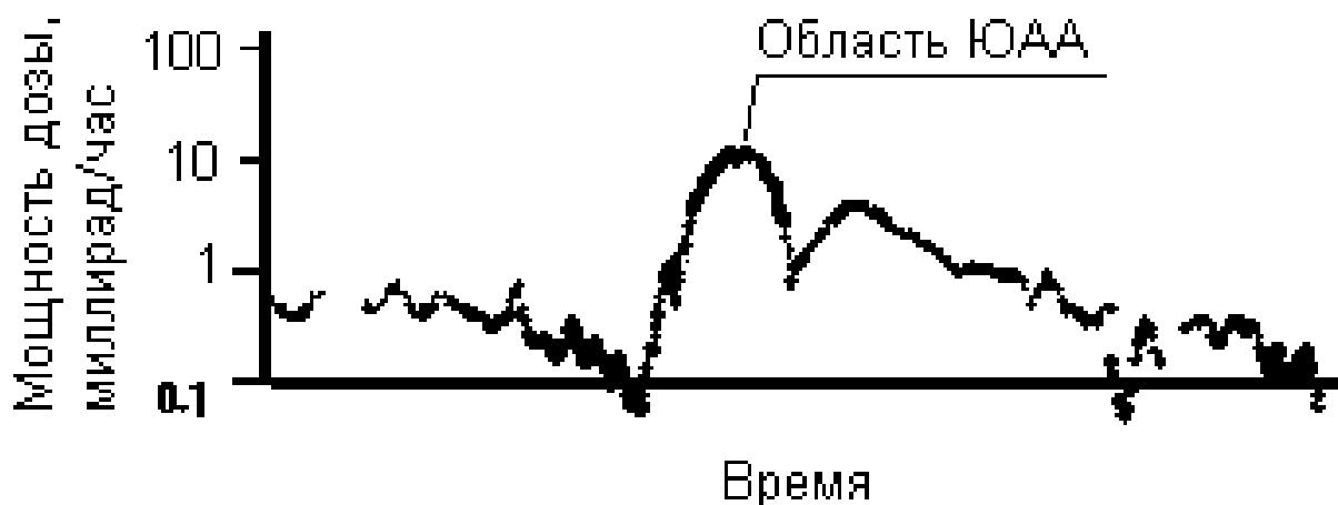
Рис. 4. Мощность дозы, зарегистрированная 1 ноября 2003 г. незащищенным детектором блока ДБ-8 №1 на нисходящем участке траектории.
